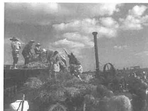
Le "mondine" sulla trebbiatrice e la ciminiera della caldaia che aziona l'antico macchinario
